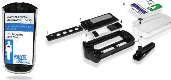
2 pav. Dozimetro sudedamosios dalys: 1- slankiklis su kapsulėmis, 2 - laikiklis su plastiko, aliuminio ir vario filtrais, 3 - neutronų detektorius (papildomai), 4 - dinaminės apšvitos elementas (papildomai), 5 - dėklas, 6 – etiketė.
