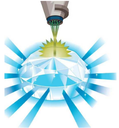
1 pav. Dozimetro aliuminio oksido kapsulės sužadinimas.
